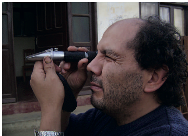
Foto 9.7. Lectura del contenido de azúcar con refractómetro analógico.
