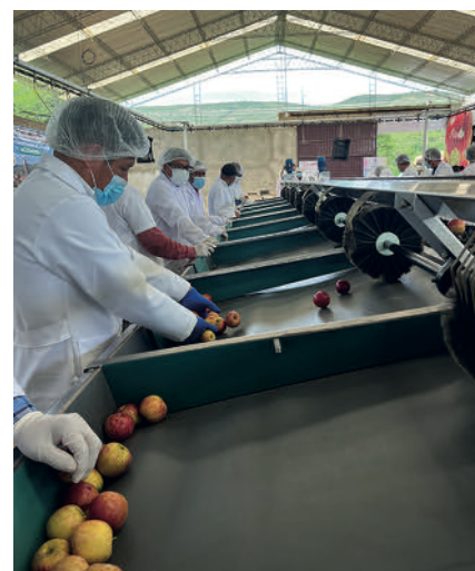
Foto 10.9. Salida de la manzana por calibre a las cajoneras fijas, FRUTA DE MI TIERRA - Vallegrande (gentileza Mario Rocabado).
