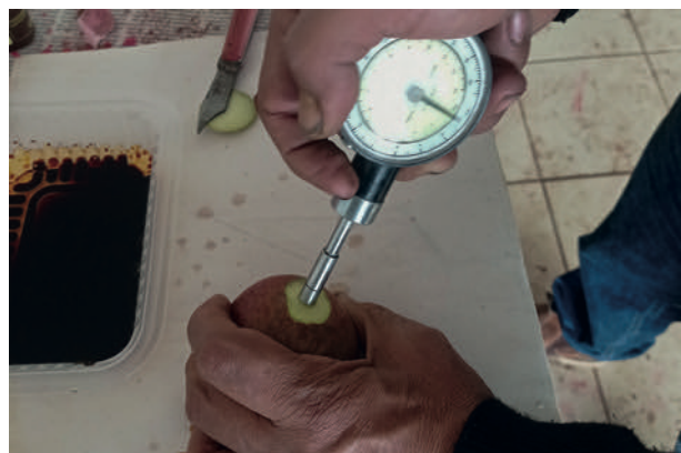
Foto 9.3. Medición de la presión de la pulpa en manzana (gentileza Diego Vicente Gutiérrez C.)
